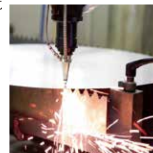
●チタンやニッケル、ハステロイなど、多彩な実績を積んだレーザ加工。3次元形状・微小孔明けに対応しています。
