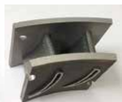
●エアインテークのための細穴加工と ブレード内部への形彫放電加工
