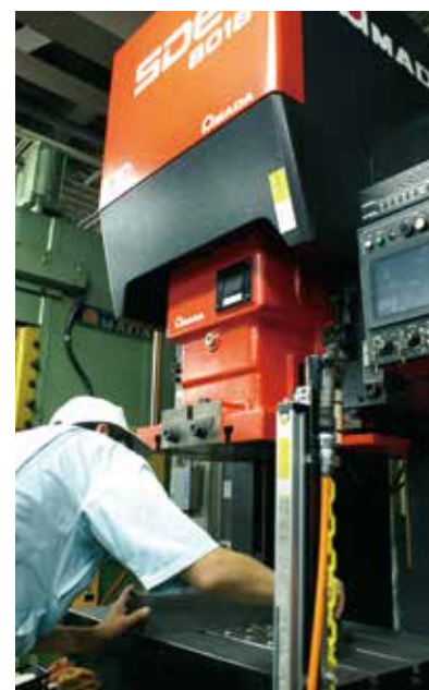
●プレス加工機への金型取付 プレス加工は、金型を使って一定量の加工をスピーディに行う場合に活躍します。金型を使用しないレーザカットと、条件に応じて使い分けています。
