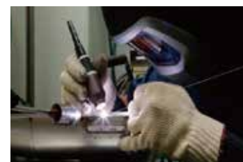
●航空機部品のTIG溶接 アルミ・ステンレスはもちろん、ジェットエンジンで多く使用されているニッケル合金・ハステロイ・チタンの溶接に高い技術を持っています。
