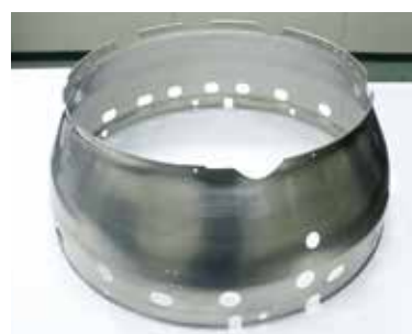
●エンジンカバー部品 エキスパンド成形と端面カール成形後、三次元レーザ加工を行います。
