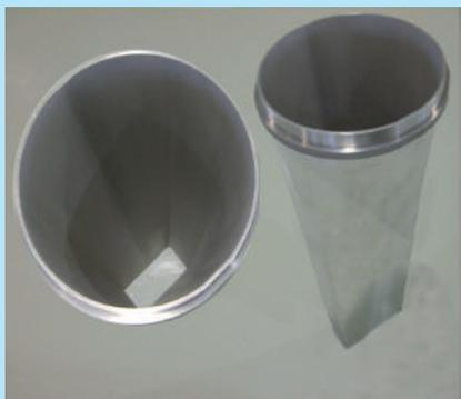
上下異形状のサンプル加工(ノズルリング部分品)
