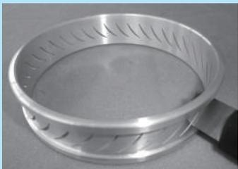
円弧方向に曲面穴を施した加工例
